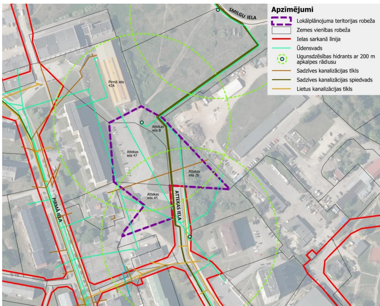
Attēls 11. Esošā ūdensapgādes, sadzīves kanalizācijas un lietus kanalizācijas sistēmas shēma
