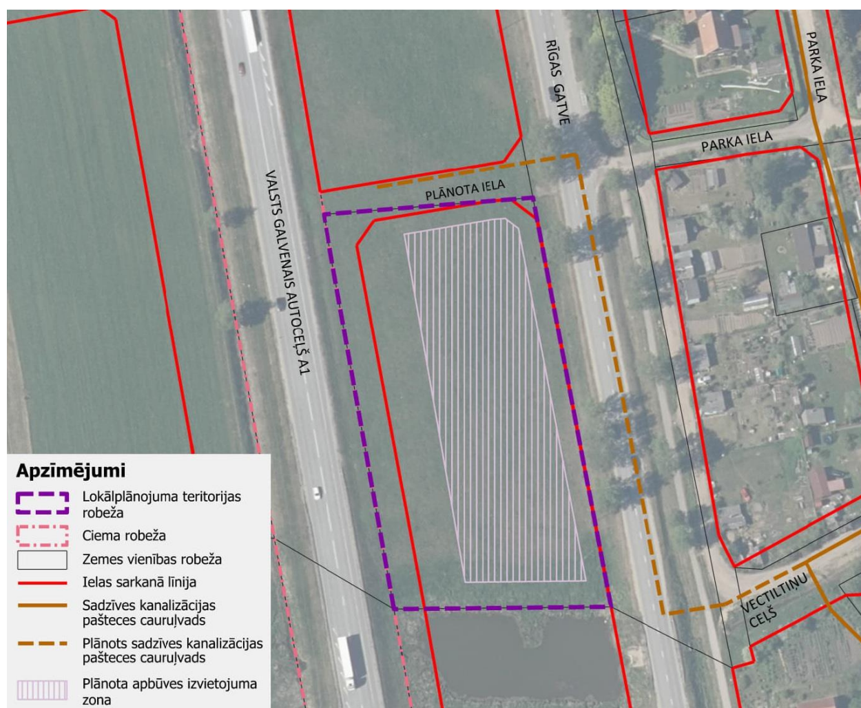
Attēls 12. Sadzīves kanalizācijas un lietus notekūdeņu shēma
