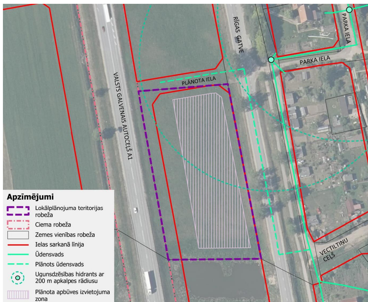
Attēls 11. Ūdensapgādes un ugunsdzēsības ūdensapgādes shēma
