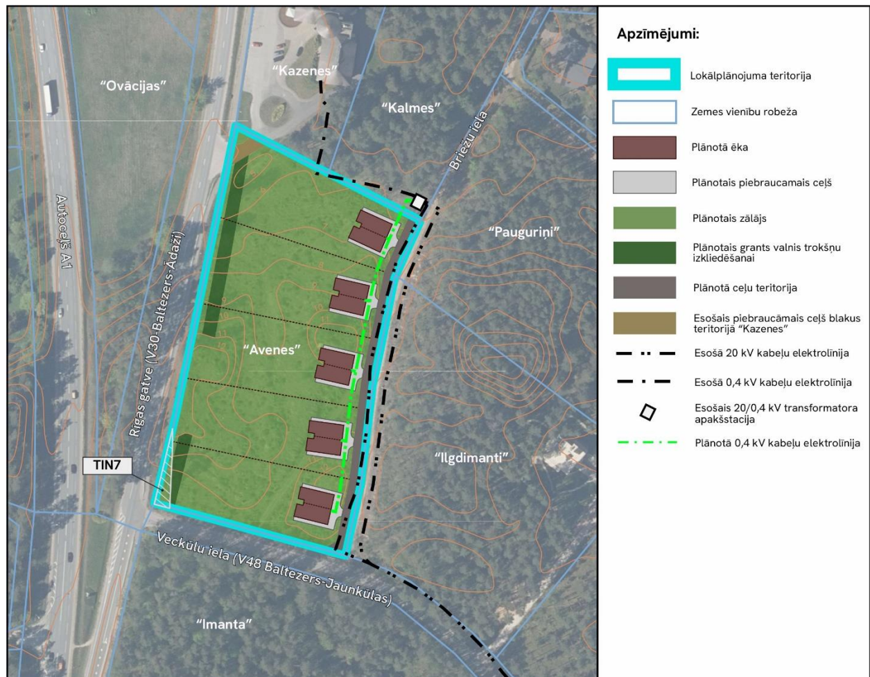
Attēls 6.5.2 Plānotās elektroapgādes shēma 26
