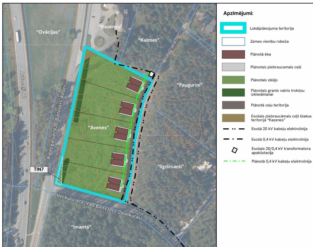
Attēls 6.5.2 Plānotās elektroapgādes shēma 26
